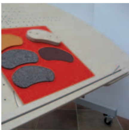
53. Verbindungsträger als Anschlagschiene (bei eingesetztem Bauchausschnitt)
